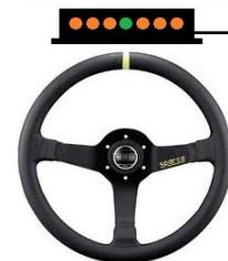
Une des nombreuses forces du Rallye Pack 2 est de permettre au pilote de se réguler tout seul grâce à sa rangée de LEDs qu'il a juste sous les yeux (**DANS L'AXE et AU DESSUS du VOLANT pour une EFFICACITE OPTIMUM !!**).
